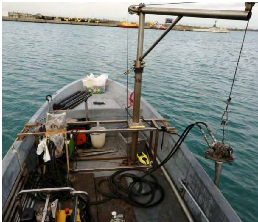
Campionatore tipo Shelby collegato a testa vibrante e centralina oleodinamica (foto d'archivio)
