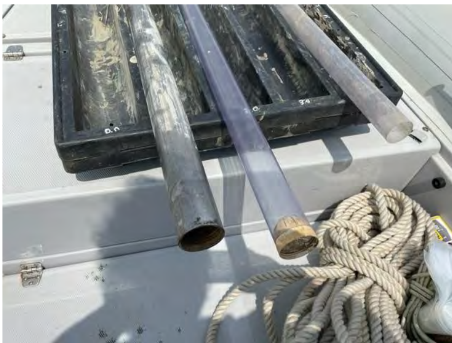
Campionatore in acciaio con fustella in PVC atossico
